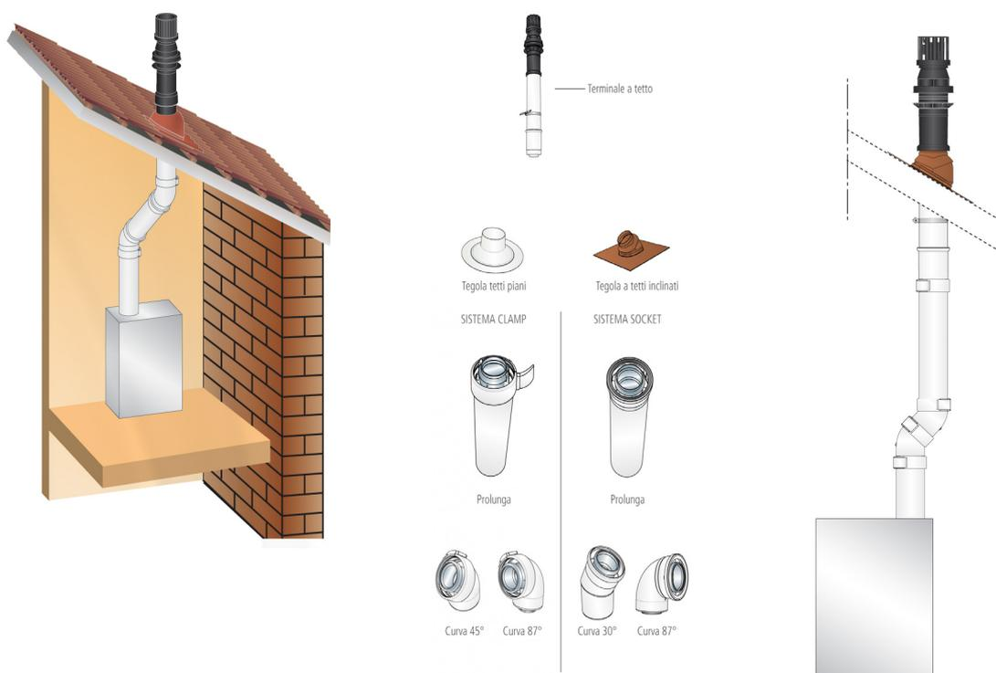
**1** Definire la posizione di uscita del terminale a tetto. Effettuare foro nella falda del tetto di dimensioni adeguate per permettere il passaggio del terminale a tetto. (cf. "Istruzioni di montaggio CE" pag. ).
